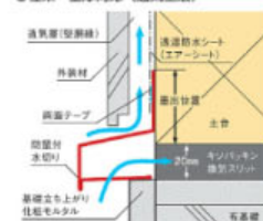
●在来・壁厚対応 (通気工法)
